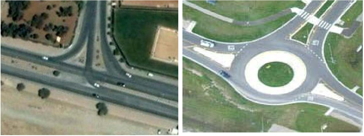
Resim 4: Soldaki resim “Fuar kontrolsüz Kavşağının” uydur görüntüsü. Sağdaki resim de ise benzer bir kavşakta çember ile yapılan çözüm.
